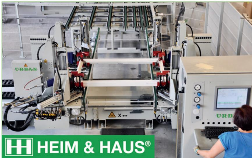
alte Fertigungslinie durch eine neue Vierkopf-Schweißmaschine vom Typ AKS 6400 und eine Schweißraupenverputzmaschine SV 840 ersetzt.
