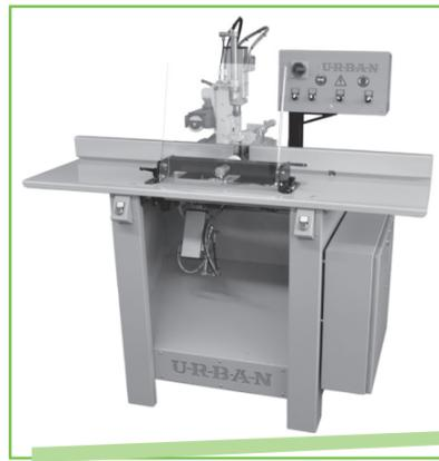
Wasserschlitzfräse WS 203 HF
