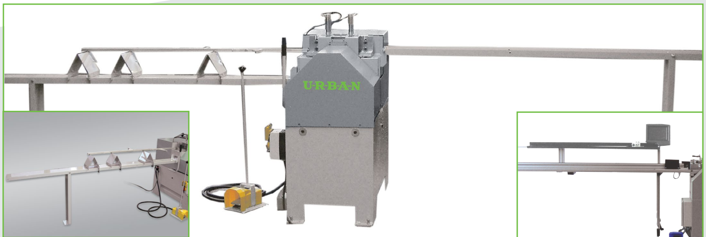
GLS 102 mit Messtaster 1,5 m und Profilauflage 3 m (auch mit 6 m erhältlich)
