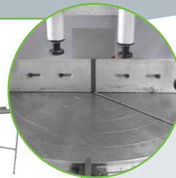
Manuelle Zwischenwinklereinstellung nach Skala, klemmbar
